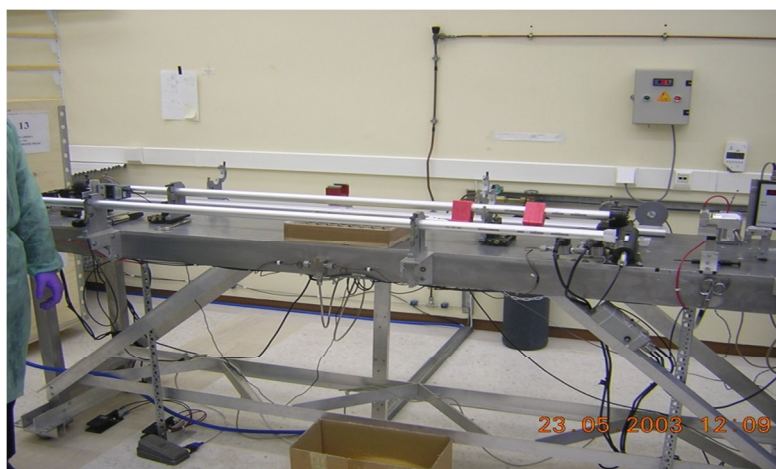
Κατασκευή θαλάμων μυνίων στο Πανεπιστήμιο Αθηνών
